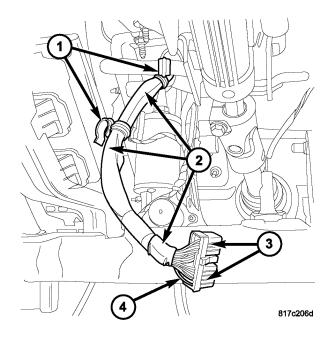
Fig. 2 TCM JUMPER HARNESS CONNECTOR
