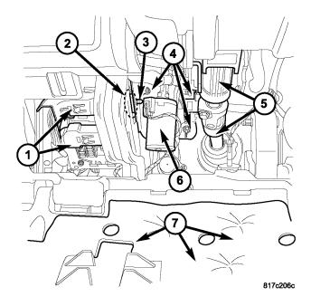
Fig. 1 TCM CONNECTOR LOCATION IN IP
