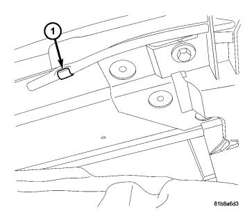
Fig. 5 CONDUIT RETAINER CLIP
